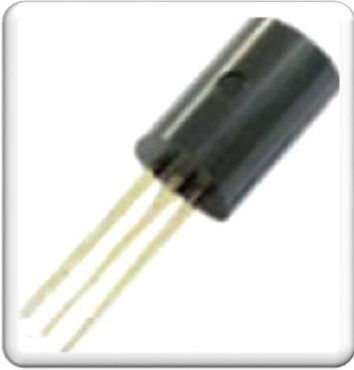
الصورة (8) الترانزستور الضوئي
