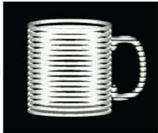
Figure 1-2-4 (Z Print Model Layers)
