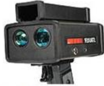
الصورة (7) تبين الرادار الذي يستخدم للكشف عن السيارات المخالفة للسرعة القانونية.
