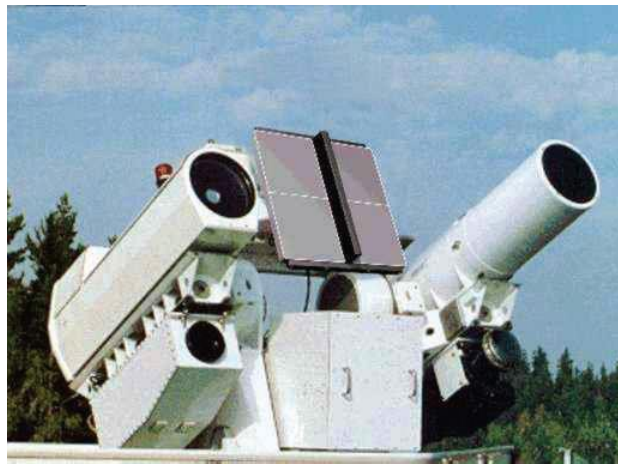
الصورة (5) تبين الرادار الذي يعمل بالأمواج المستمرة.
